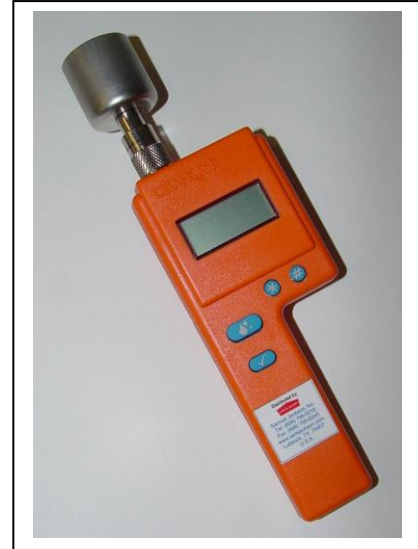
Humidimètre C-2000 (Référence 16001A) équipé de l'électrode à coupelle pour le coton-graine type 52-E/C (Référence 16003A)
