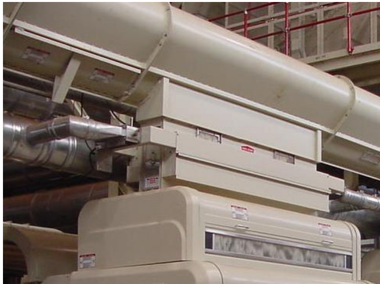
Trémie de conditionnement avec double entrée pour égreneuses à forte capacité (Modèle CH-96-1225 avec entrée d'air humide aux extrémités)
